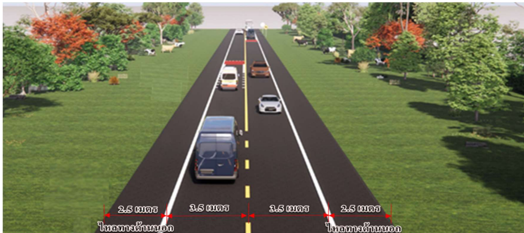
รูปที่ 8.3-3 รูปแบบแนวคิดเบื้องต้น สำหรับถนนขนาด 2 ช่องจราจร
