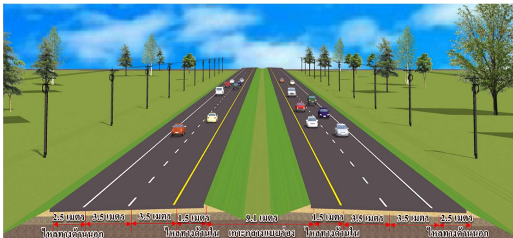
รูปที่ 8.3-4 รูปแบบแนวคิดเบื้องต้น สำหรับถนนขนาด 4 ช่องจราจร
