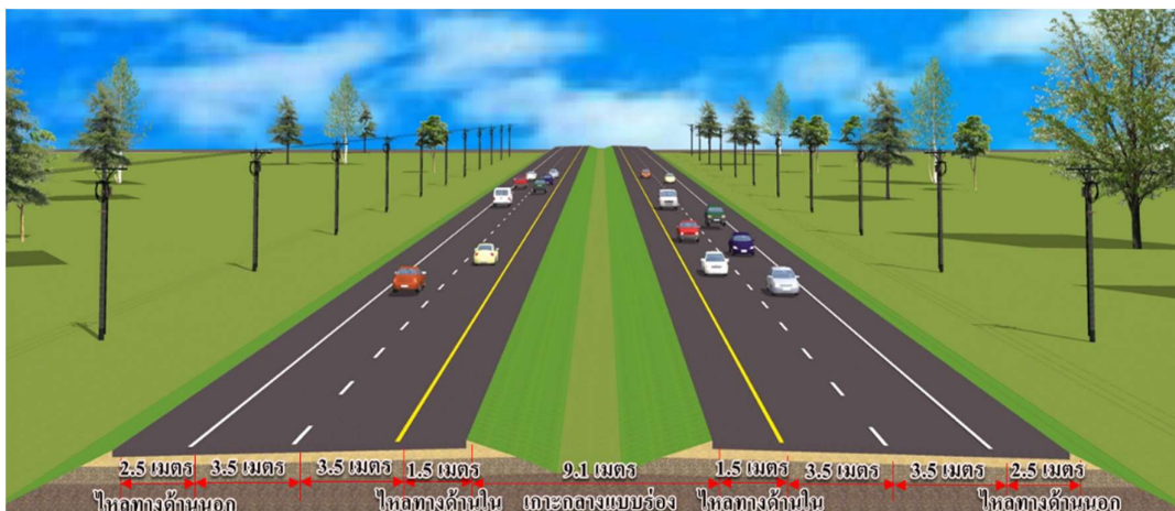
รูปที่ 8.3-4 รูปแบบแนวคิดเบื้องต้น สำหรับถนนขนาด 4 ช่องจราจร
