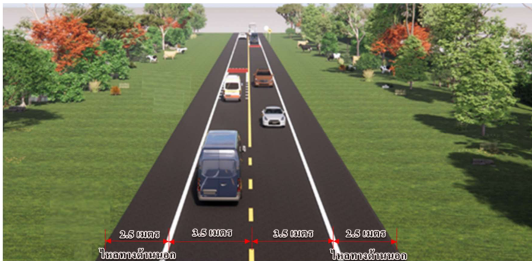
รูปที่ 8.3-3 รูปแบบแนวคิดเบื้องต้น สำหรับถนนขนาด 2 ช่องจราจร
